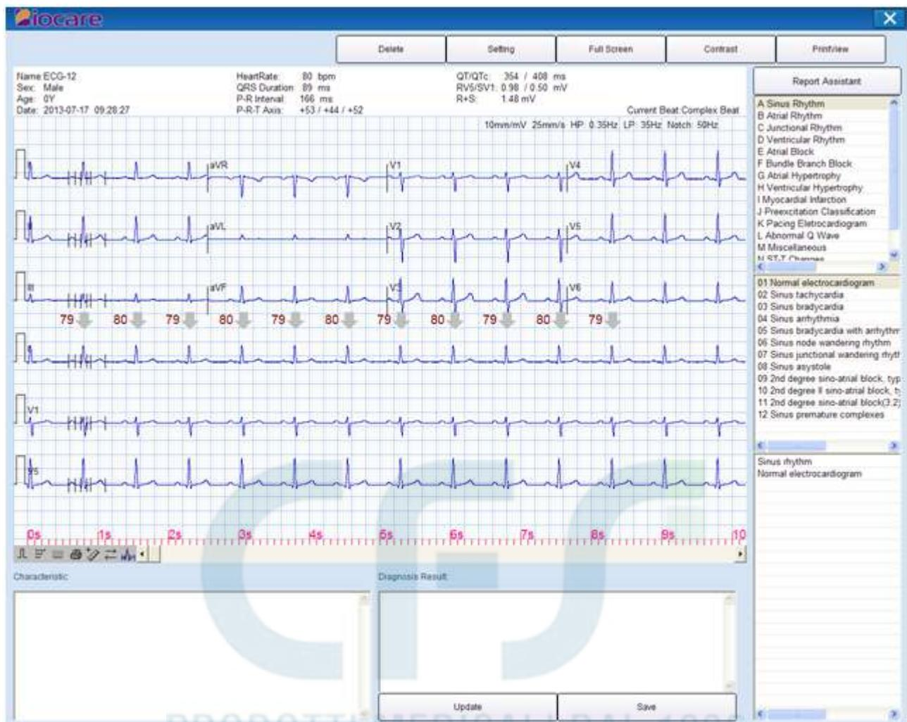
Fig 4.5.17 Interfaccia rivedi & analisi 12-derivazioni in modalità  $3 \times 4\_C + 3$
