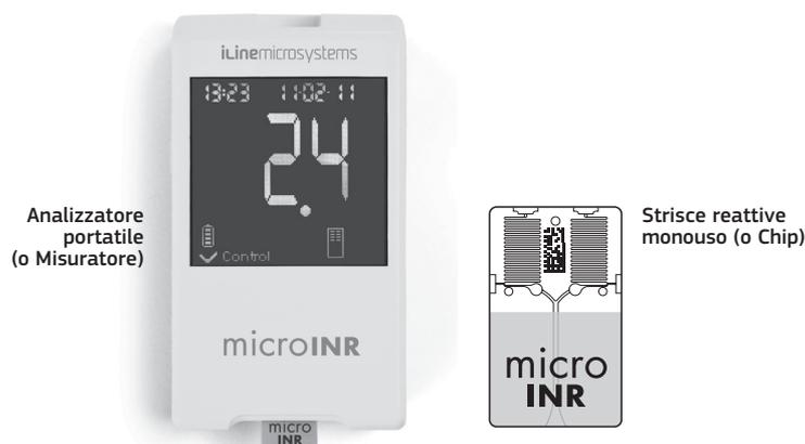
Il coagulometro portatile microINR è indicato per la determinazione della coagulazione del sangue (tempo di protrombina) mediante la misurazione dei seguenti parametri: tempo di protrombina (PT) e rapporto normalizzato internazionale (INR). Entrambi questi parametri forniscono informazioni sul percorso di coagulazione estrinseco.
