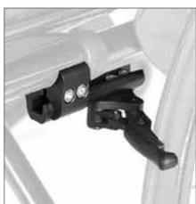
Rimuovere i freni di stazionamento standard allentando la clamp fissata sul telaio. Introdurre il supporto del freno radiale di stazionamento nella stessa posizione. Prima di fissare le viti regolare la posizione del freno di stazionamento in inclinazione e profondità fino alla posizione utile per una buona frenata.
