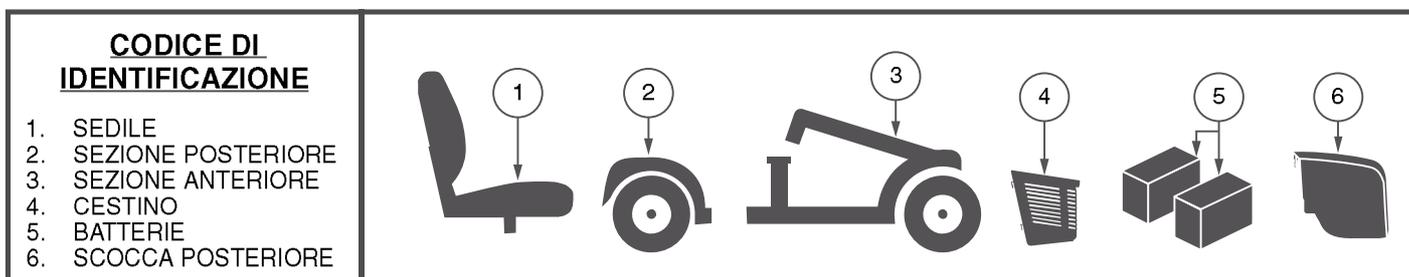
Figura 21. Scooter smontato
