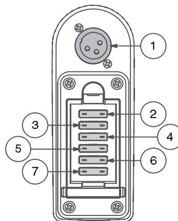
**Figura 4. Alloggiamento cavo alimentazione caricatore/ Fusibili console manubrio**
