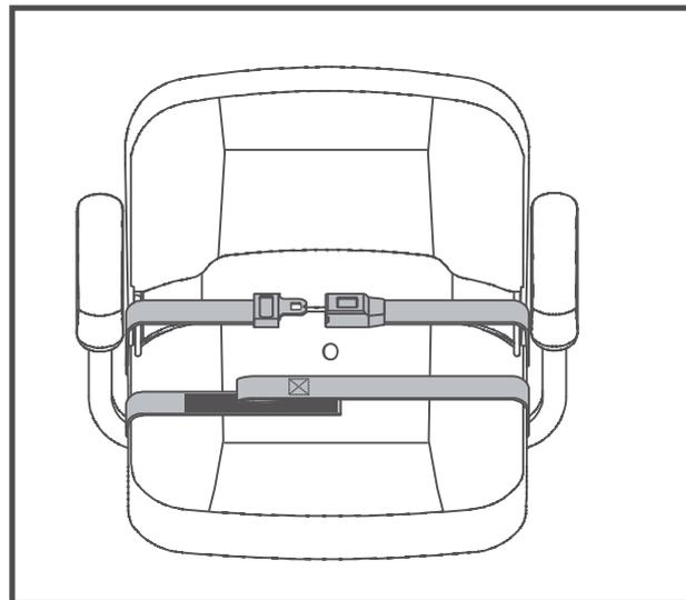
**Figura 20. Cinture di sicurezza - Cintura di sicurezza con aggancio metallico o con gancio riutilizzabile e velcro**
