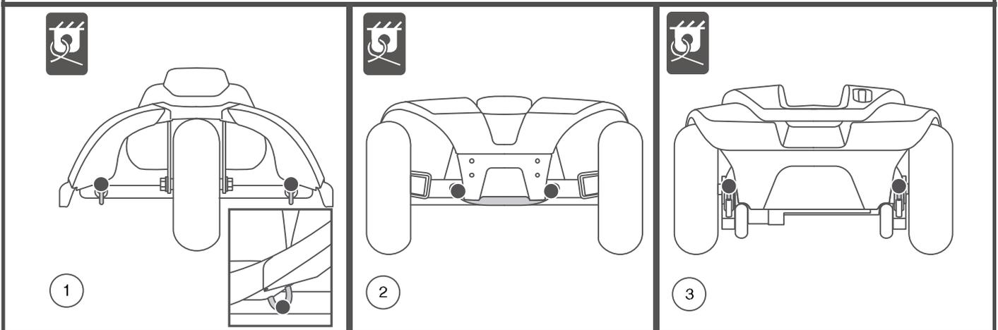
Figura 7. Punti di fissaggio (Identificati dai punti neri)
