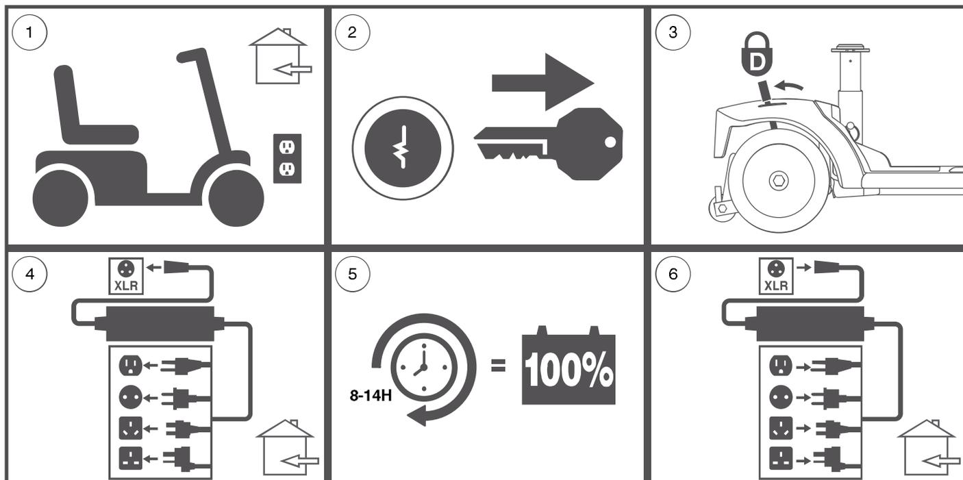
Figura 9. Schema delle procedure di ricarica della batteria
