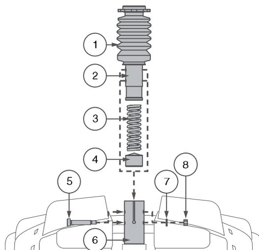
Figure 18. Regolazione dell'altezza del sedile - pistone del sedile ammortizzato
