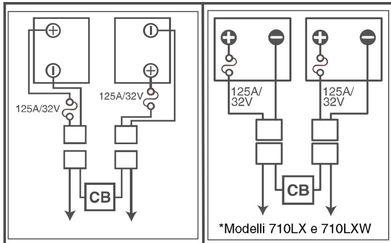
Figura 13. Diagramma di cablaggio della batteria
