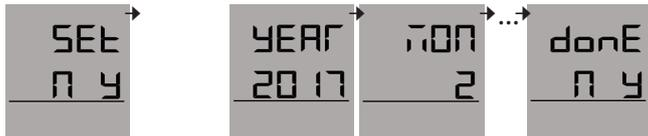
Möchten Sie das Datum korrigieren? N = Nein durch Drücken der Mode-Taste auswählen, der Logger kehrt in den Normalmodus zurück. Oder Y = Ja durch Drücken der Starttaste auswählen, nachfolgende Sequenz beginnt:
