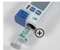
Leere Batterie entnehmen und neue Batterie wie abgebildet einlegen.
