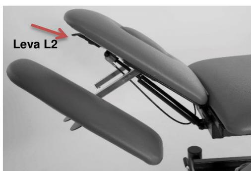
La testata è regolabile mediante molla a gas con sblocco controllato tramite apposito comando. Per regolare l'inclinazione della sezione premere il comando (L2) e regolare nella posizione desiderata; rilasciare la leva L2 per mantenere la posizione raggiunta.
