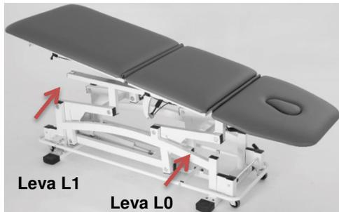
Può assumere la posizione TRENDELENBURG. La sezione centrale e finale sono regolabili mediante molla a gas con sblocco controllato tramite apposito comando. Per ottenere la posizione premere i comandi (L0 e L1) e regolare nella posizione desiderata; rilasciare la leva L0 ed L1 per mantenere la posizione raggiunta.
