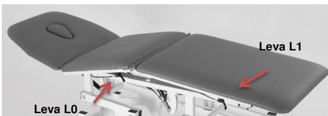
La sezione finale è regolabile mediante molla a gas con sblocco controllato tramite apposito comando. Per regolare l'inclinazione della sezione finale premere il comando (L1) e regolare nella posizione desiderata; rilasciare la leva L1 per mantenere la posizione raggiunta.
