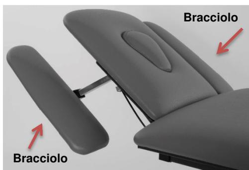
I braccioli posti sullo schienale sono regolabili manualmente. Per regolare la posizione svitare il volantino, posizionare il bracciolo nella posizione desiderata e avvitarlo per bloccare la posizione. Ripete l'operazione con il secondo bracciolo.
