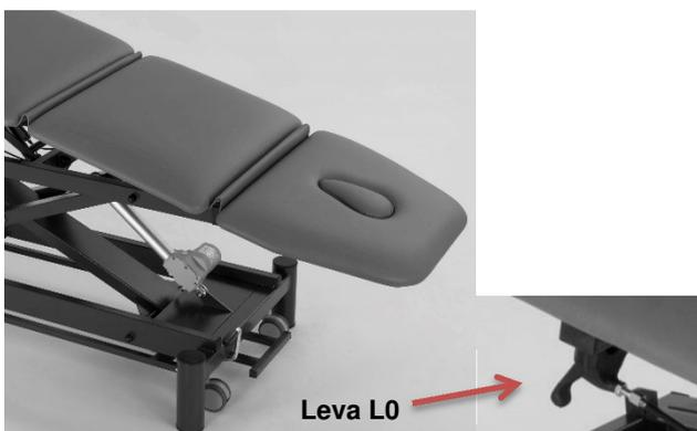
La sezione centrale è regolabile mediante molla a gas con sblocco controllato tramite apposito comando. Per regolare l'inclinazione della sezione centrale agire sul comando (L0) e regolare nella posizione desiderata; rilasciare la leva L0 per mantenere la posizione raggiunta.
