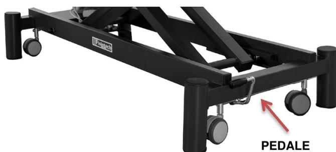
Per inserire le ruote retrattili spingere con la pianta del piede il PEDALE fino a fine corsa; per disinserire sollevare con il dorso del piede il PEDALE per far risalire le ruote.
