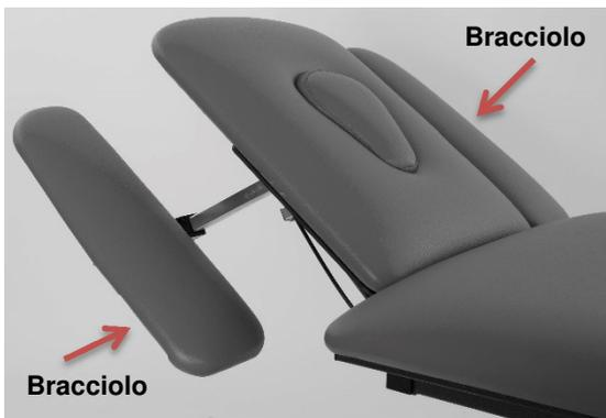
I braccioli posti sullo schienale sono regolabili manualmente. Per regolare la posizione svitare il volantino, posizionare il bracciolo nella posizione desiderata e avvitare il volantino per bloccare la posizione. Ripetere l'operazione con il secondo bracciolo.
