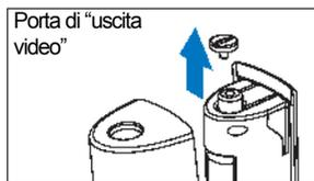
1. Collegare un'estremità del cavo di connessione all'uscita video sul dispositivo e l'altra alla porta video del monitor.
