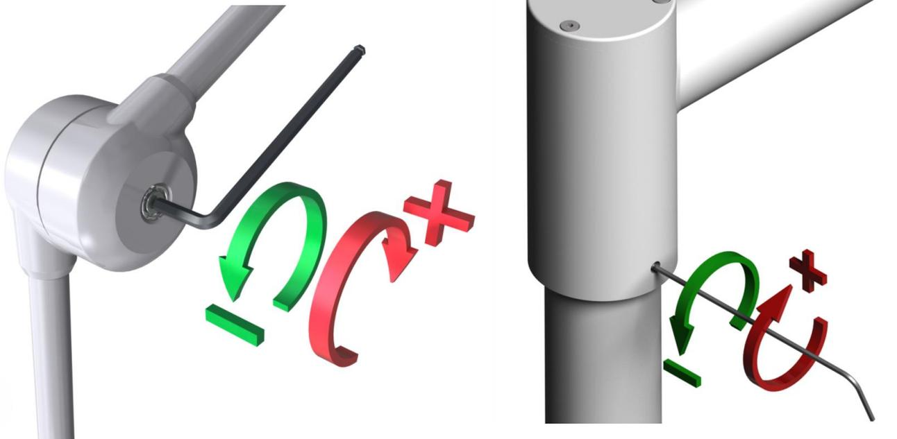
In corrispondenza dello snodo interessato, utilizzando la chiave esagonale, agire sulla vite di regolazione posta a lato dello snodo.
