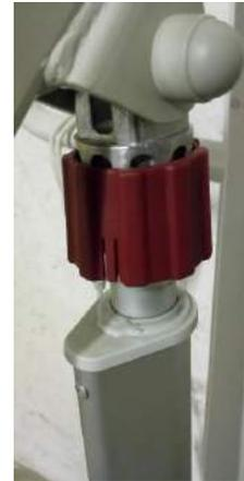
Quando la ghiera di sicurezza è abbassata, è possibile, avvitando/svitando la stessa, alzare o abbassare manualmente il braccio di sollevamento.
