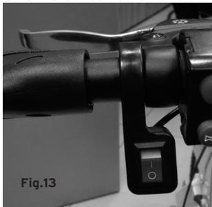
Il pulsante di retromarcia si trova sulla sinistra del manubrio, a lato alla leva del freno e del cruise control (Fig.13). Portare il pulsante su "I" per attivare la retromarcia, riportare su "O" per la marcia in avanti.
