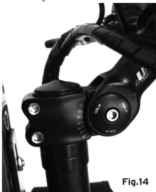
Per regolare l'altezza e l'inclinazione del raccordo manubrio, svitare le viti indicate con brugola da 5 mm.
