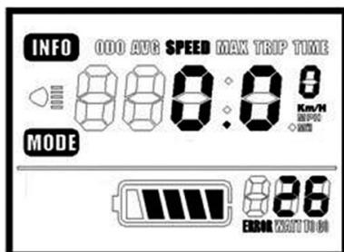
Durante la marcia, il display LCD mostra nella parte inferiore a destra, la potenza erogata dal motore. Il valore è espresso in watt.
