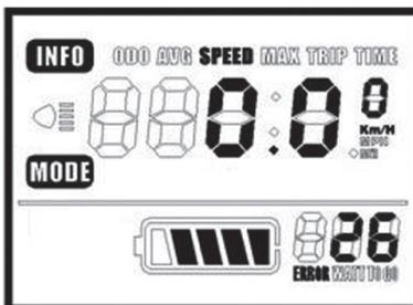
Quando il sistema elettrico di TIBODA riscontra problemi, il display visualizza automaticamente un codice di errore, nella parte inferiore destra.
