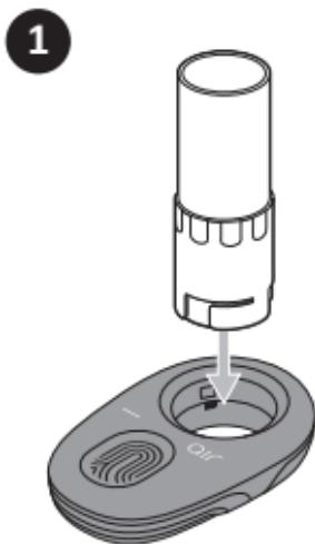
Inserte una nueva turbina deslizándola a través del dispositivo.
