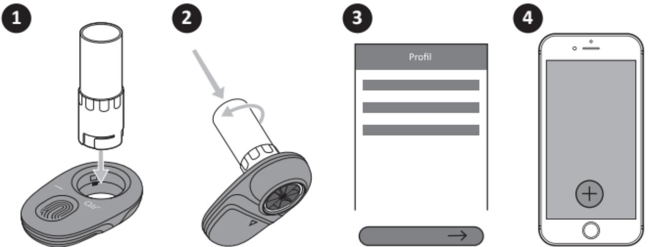
Insérez une nouvelle turbine en la faisant glisser à travers l'appareil.
