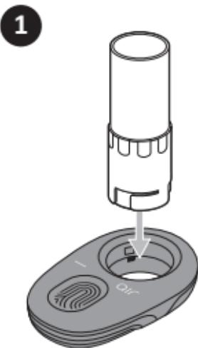
Inserire una nuova turbina facendola scorrere attraverso il dispositivo.
