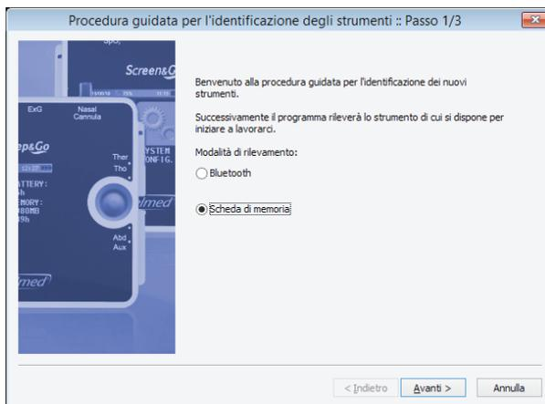
Se si dispone di un sistema Sleep&Go con modulo Bluetooth, assicurarsi che sia acceso e selezionare la porta di comunicazione Bluetooth alla quale è collegato lo strumento (è possibile verificarlo dal Pannello di controllo di Windows). In caso contrario, rimuovere la scheda di memoria dallo strumento e inserirla nel lettore di schede del PC (assicurarsi di aver spento lo strumento prima di rimuovere la scheda di memoria). Fare clic su Avanti.
