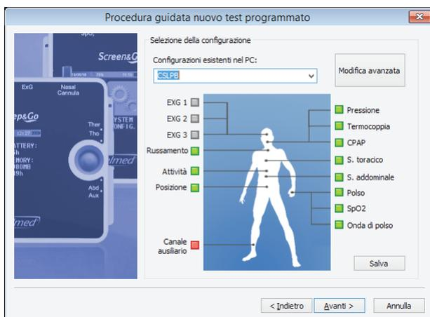
Se si dispone di un sistema Sleep&Go con modulo di comunicazione Bluetooth, è possibile programmare il test direttamente tramite Bluetooth. Assicurarsi che lo Sleep&Go sia acceso, che il Bluetooth sia stato attivato e selezionare la voce Tramite Bluetooth. Fare clic su Avanti.
