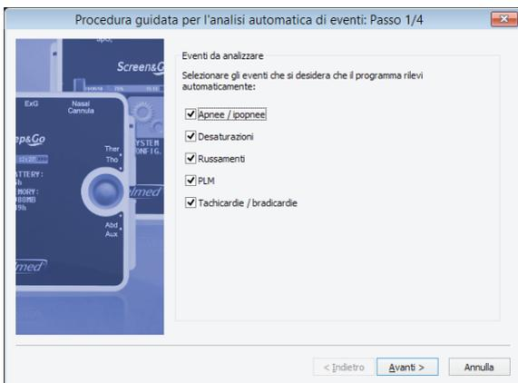
Nel passo successivo della procedura guidata, selezionare la parte del test che si desidera analizzare. Se si desidera scartare un periodo fisso all'inizio e/o alla fine del test, spuntare la voce *Scarta periodi all'inizio e/o alla fine del test* e digitare il numero di minuti che si desidera scartare in ciascun caso.
