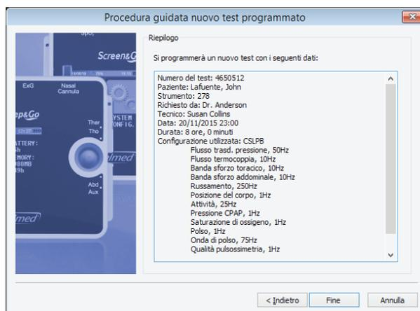
Se il test è stato programmato tramite la scheda di memoria, attendere che il programma avvisi che la programmazione sia stata effettuata con successo. Rimuovere la scheda dal lettore di schede e inserirla di nuovo nello strumento. Accendere lo strumento e attendere che venga visualizzata la schermata principale (in cui appare la voce Avvio manuale). Lo strumento rileverà il nuovo test e sarà pronto per l'uso. Adesso è possibile spegnere lo strumento.
