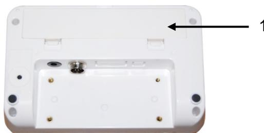
Aprire il coperchio del vano accumulatore (1) nel basso del display e collegare l'accumulatore. Prima del primo uso l'accumulatore va messo in carica per almeno 12 ore.
