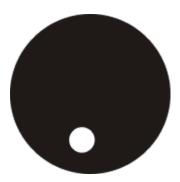
4. Usando le viti di centraggio del supporto del condensatore, portare l'immagine del diaframma di campo al centro del campo visivo.
